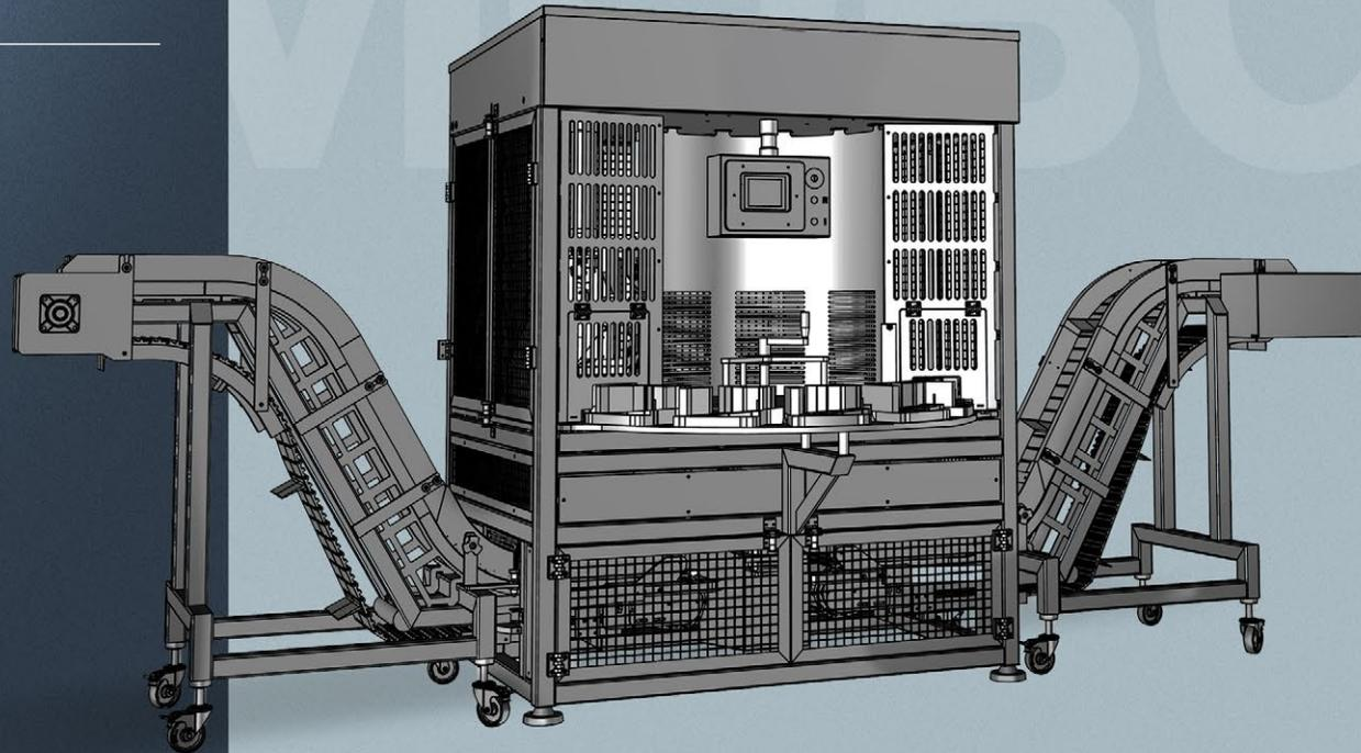
— Machine flexible avec possibilité d'avoir plusieurs jeux d'empreintes, les systèmes de coupe étant ajustables.
